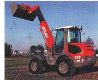
Mit dem AR 75 T hat Atlas jetzt auch einen Radlader mit Teleskoparm im Programm.
